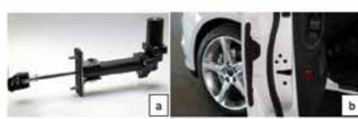
**Şekil 2.** a) Kanadalı bir firma tarafından geliştirilen sönüz konumu kapı menfesesi [www.multiinc.com] b) Ford Focus aracı için geliştirilen kapı darbe koruma sistemi
