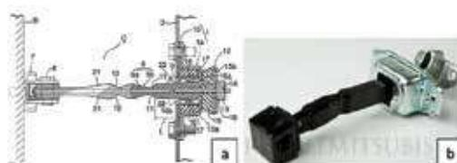
Şekil 1. a) Mırcıv otomobillerdeki kapı konumlayıcı mekanizmalarla örnek olabilecek, Honda' ya ait US6813811B2 nolu patentten bir görüntü. b) Mitsubishi Eclipse aracına ait kapı konumlayıcı mekanizma
