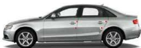
**Şekil 4.** Projede gerçekleştirilecek sisteme, kapı üzerinde konumlanacak sensörlerin öngörü konumları (Kırmızı renkli konumlar).
