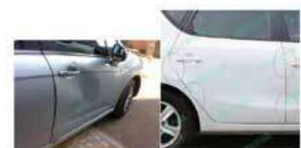
Şekil 3. Çarpma sonucu araç kapısında meşaleden gizli kemerin sıkılması
